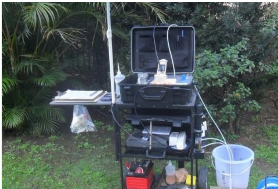
Figura 4: Poço de monitoramento com análise de contaminantes no local.
