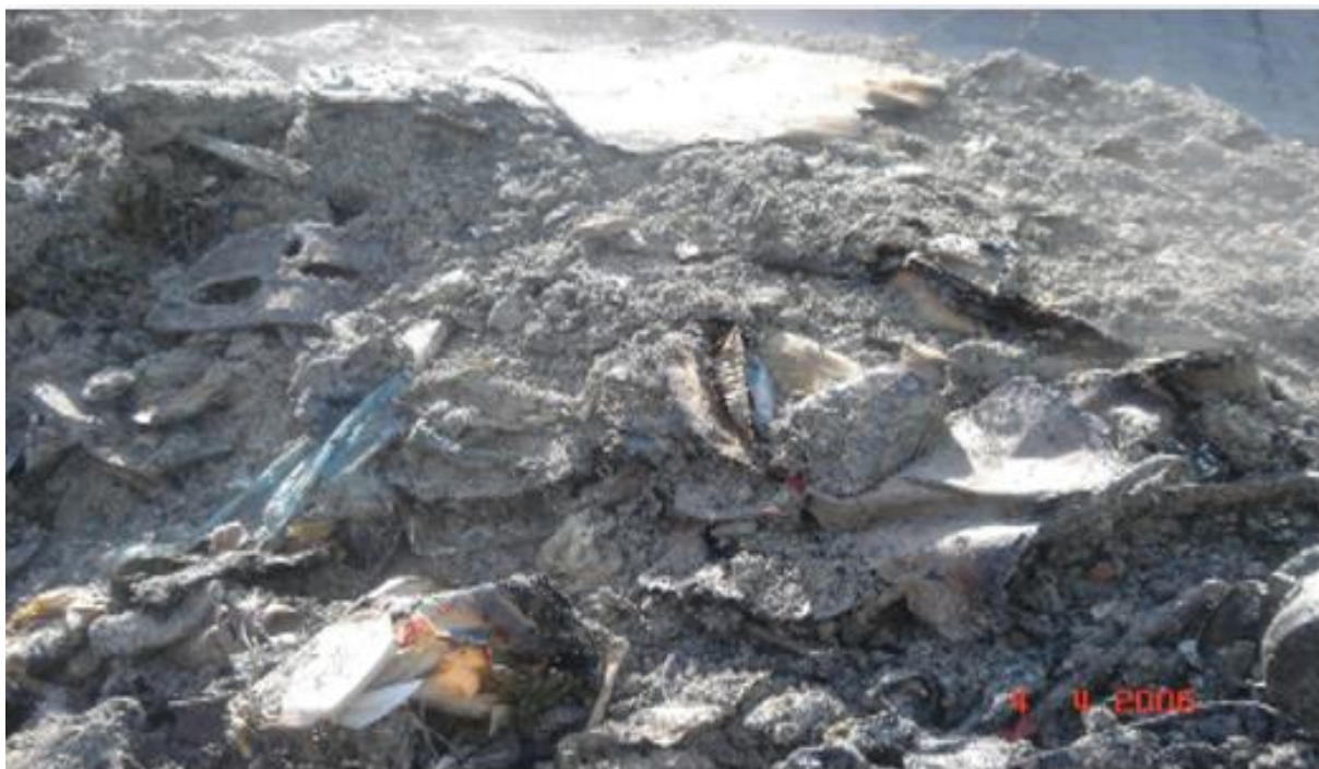
Figura 4 – Detalhe das escórias e cinzas do Incinerador com recuperação de energia da cidade de Kempten, Estado da Baviera – Alemanha, onde se observa que os Resíduos Sólidos Urbanos não queimam por completo, inclusive materiais combustíveis, como papel e papelão, gerando resíduos perigosos, o que exige uma disposição em locais apropriados para receberem resíduos perigosos. ( Fonte: Acervo da Ecel Ambiental, 2006)
