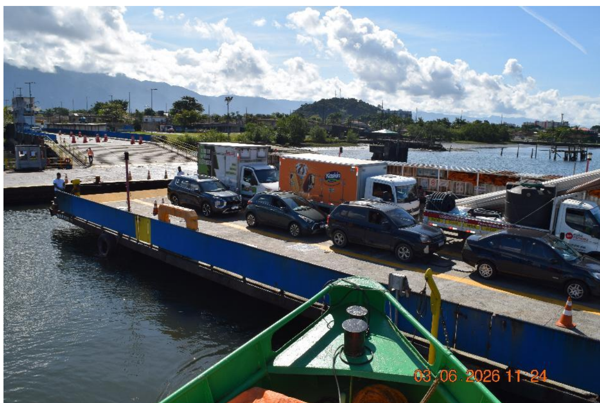
Figura 17: Manobra de desatracação da barcaça em Bertioiga é feita na propulsão reversa pois, em maré baixa, o empurrador pode abalroar o leito do canal
